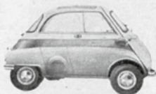
BMW bot zum Umsteigen vom Motorrad die Isetta an (250/300 ccm, 12/13 PS) – 1962 eingestellt
